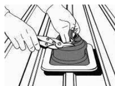
1. Dektite an Rohr anpassen
