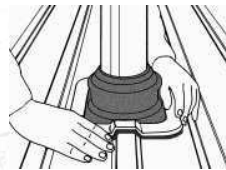
4. Dektite formgenau an Profilblech anpassen.
