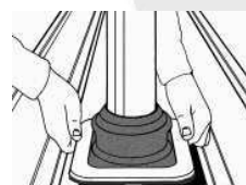
2. Dektite an Profilblech anpassen und markieren.
