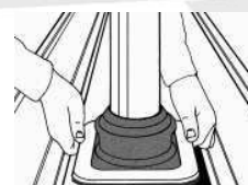
2. Dektite Ezi-Seal an Profilblech anpassen und markieren.
