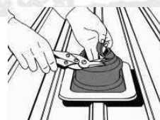
1. Dektite Ezi-Seal an Rohr anpassen
