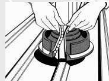
2. Dektite Retrofit um das Rohr legen und die Metallverschlüsse schließen (von oben nach unten)
