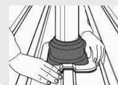
3. Dektite Ezi-Seal formgenau an Profilblech anpassen.
