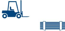
Bei kurzen Paketen bis 6 m kann das An- oder Abheben auch mittels Stapler sachgemäss und mit geschützten Gabeln (z. B. mit gummierten Auflagen) erfolgen.
